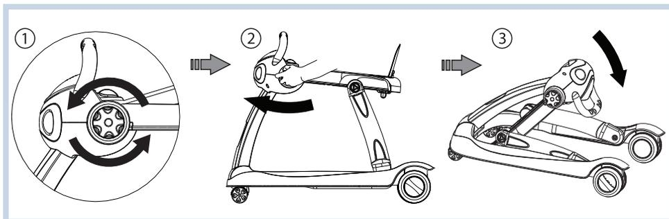
על מנת לקפל את ההליכון סובב את כפתור הקיפול שבצד ההליכון לפי הכיוון שמראה החץ בתמונה 1. ואז דחוף את גוף ההליכון כפי שמראה החץ בתמונה 2. לאחר מכן לחץ כלפי מטה לכיוון החלק התחתון של ההליכון כפי שמראה החץ בתמונה 3.
